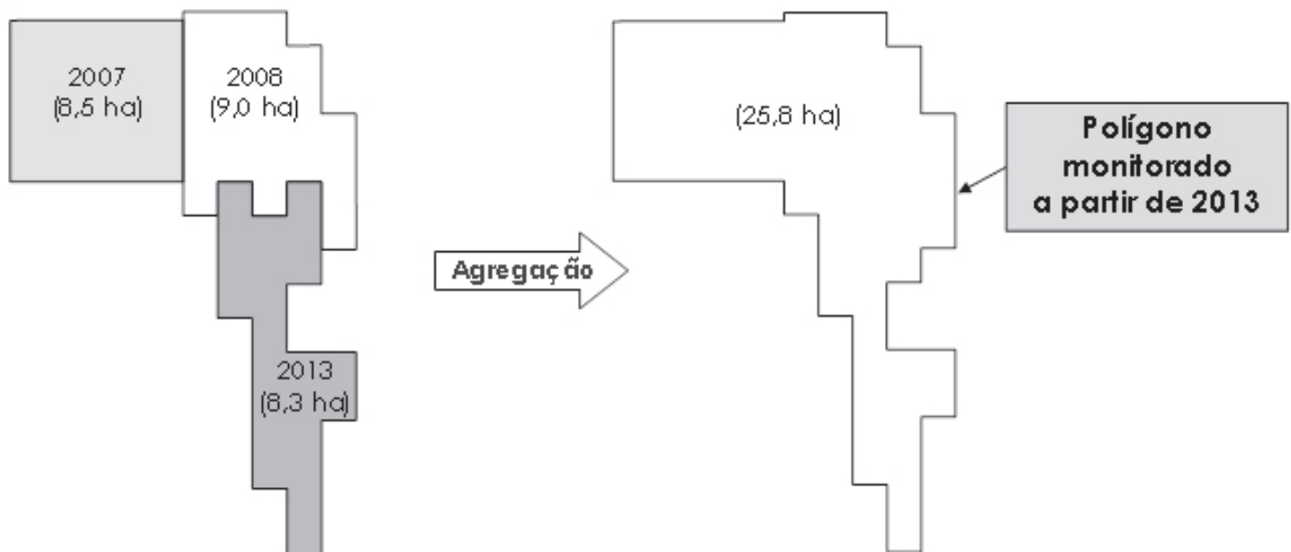
Figura 4 - Exemplo da agregação de três polígonos adjacentes do PRODES mapeados entre 2007 e 2013, formando um único polígono maior que 25 ha, que começou a ser monitorado a partir de 2013.
